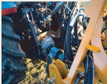
GRUPPO POMPE INNESTATE ALLA PDF
